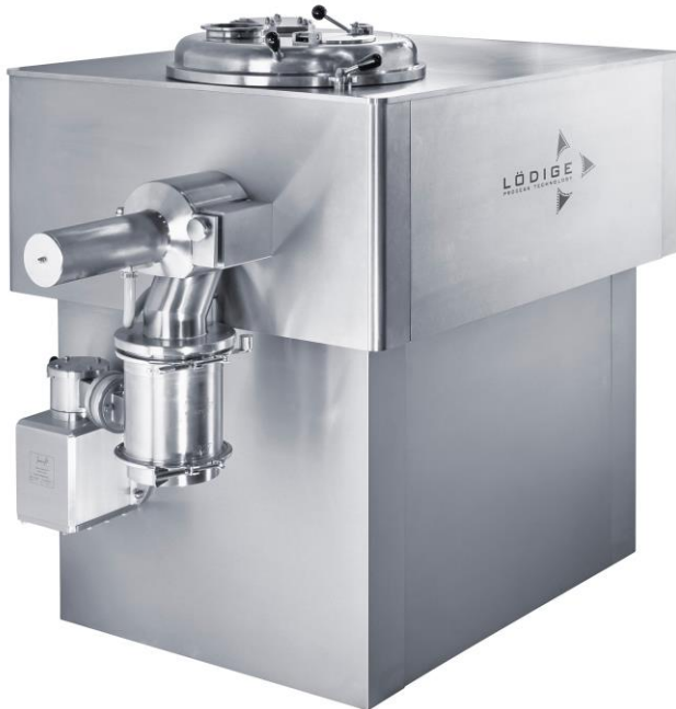
Abb. 5: Mischgranulator Typ MGT, ein vertikales Mischsystem mit niedrigem Energieeintrag und geringer Temperaturerhöhung bei hoher Mischleistung
