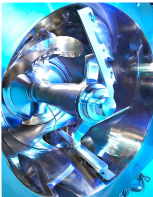
Mischraum des LDM mit Misch- und Abstreifer-Werkzeugen
