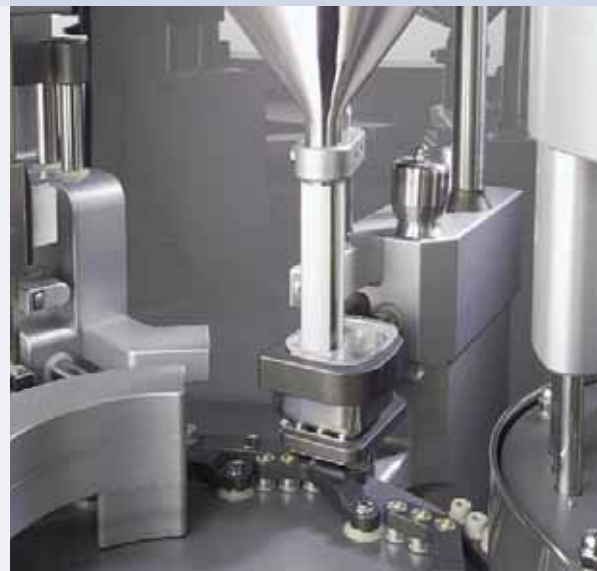
Jeder Takt bringt Leistung: Pelletdosierer mit volumetrisch einstellbarer Füllmenge.
