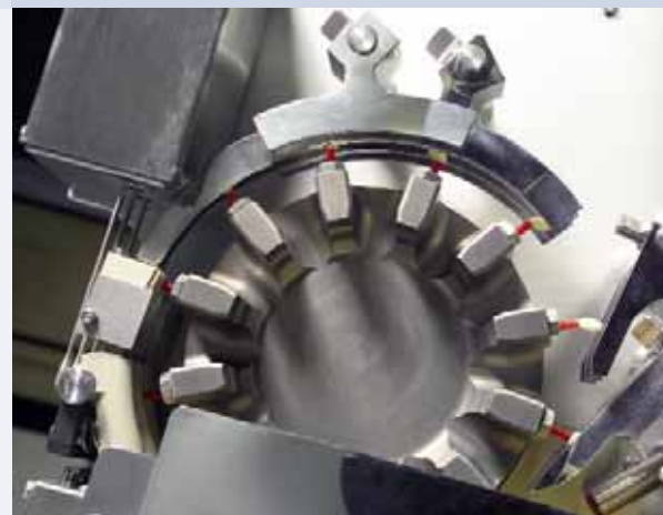
Stück für Stück: Formatfreiheit durch Vakuumansaugung – das große Plus bei der Tablettenzuführung.
